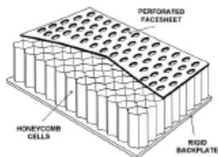
Figure 5. SINGLE LAYER LINER
